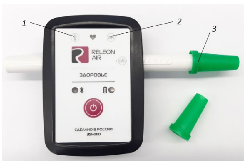
Рис. 2. Мультидатчик по физиологии: 1 — температура тела, 2 — пульс, 3 — частота дыхания (надеет съёмный мундштук)
